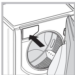
Дозатор находится внутри машины и доступен через люк.
